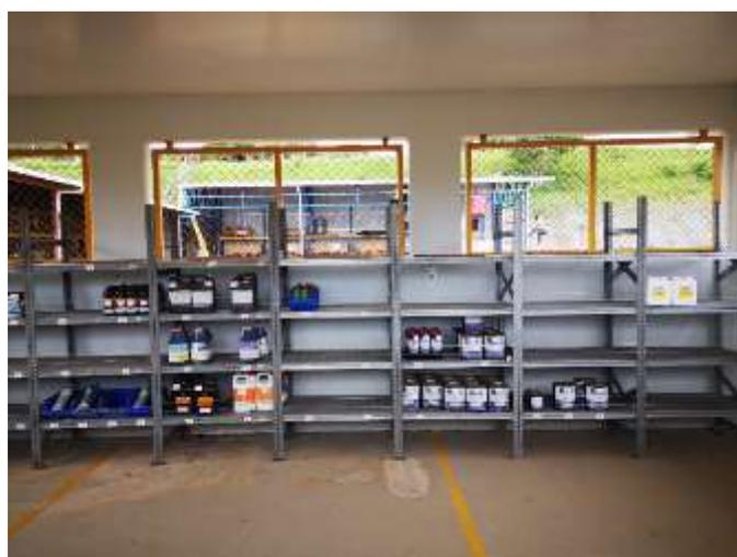
Figura 22 Almacén de sustancias peligrosas Unidad I, se cuenta con kits para el control de derrames y drenajes hacia el tanque de neutralización
