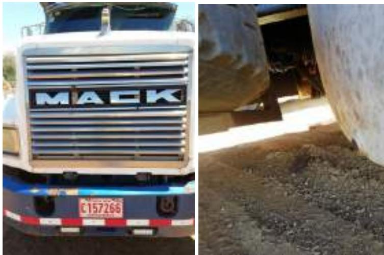
Figura 3. Detención de vagoneta con fuga de aceite.
