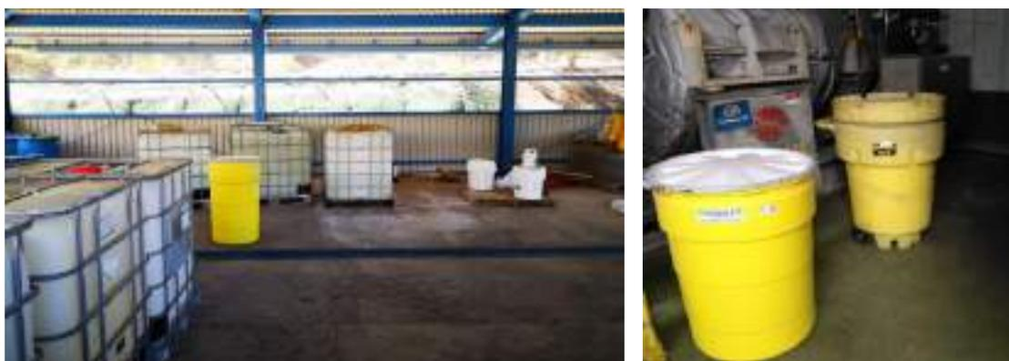
Figura 26 Almacén de sustancias peligrosas Unidad II, se cuenta con kits para el control de derrames y drenajes hacia el tanque de neutralización
