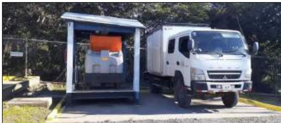
Figura 31. Tanqueta y equipos dispensadores utilizados para el despacho de combustibles
