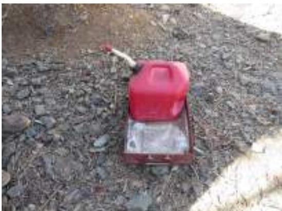
Recipiente para transporte en campo dentro de bandeja de contención con absorbente en la base.
