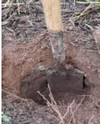
Figura 64. Estratigrafía invertida, se puede apreciar la capa de suelo rojizo a nivel superficial producto de relleno, seguida del estrato de tierra café oscura original.
