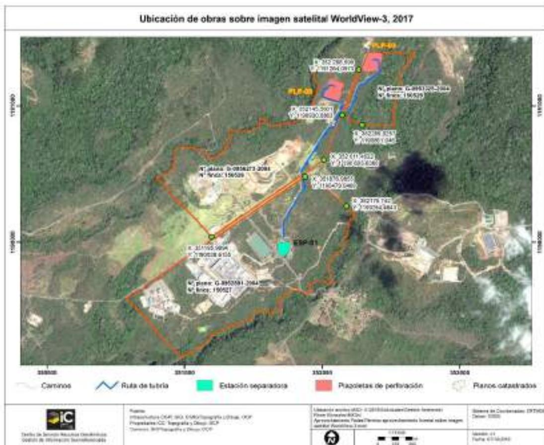
Figura 22 Ubicación del colector bifásico de los Pozos PGP-13 y PGP-16.
